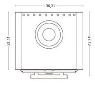
vent outlet: 4,72 Ø firebreak: 5,90 Ø
