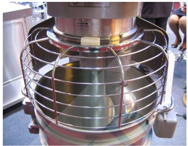
사용이 편리한 새로운 개념의 회전식 볼 부착 시스템
